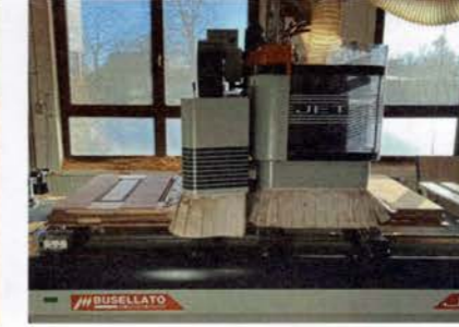
/ Auf dem CNC-Bearbeitungszentrum fertigt die Tischlerei Siegmann gerade die neue Haustür.
